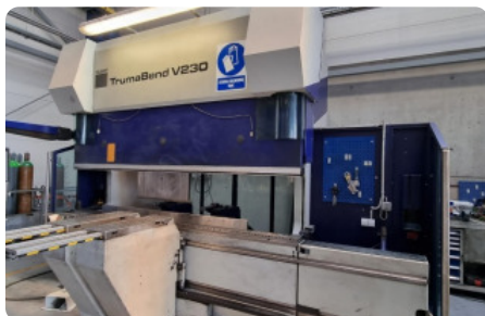
1 hydraulische TRUMPF CNC-ABKANTPRESSE TrumaBend V 230 No.888162
